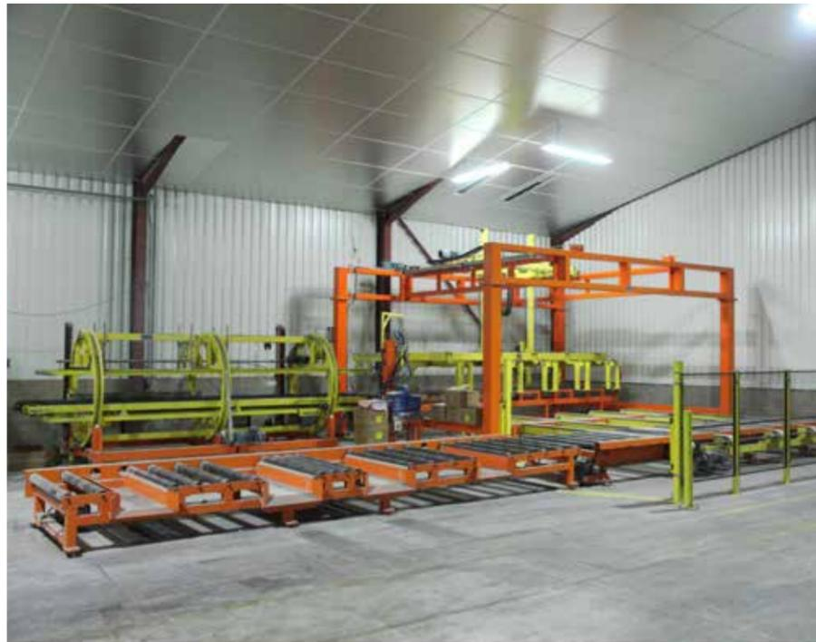
Nous avons par exemple investi dans manipulateur à ventouses pour **faciliter la manutention des plaques de plâtre** (réduction des risques de blessures et des efforts physiques quotidiens). Ou dans des équipements facilitant la manutention des blocs, tels que des **systèmes de stockage automatisés et des chariots à pinces**.
