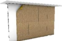
2 On déroule le rouleau Tecsound SY 70 GEO en enlevant le film de protection de sous face. La face adhésive se colle directement sur le parement support à rénover. Les lés du produit se posent bord à bord.
